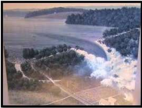
Ruptura de barragem por "Over Topping" ou Galgamento
